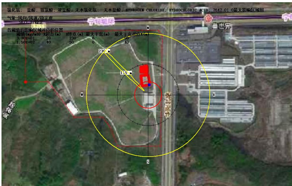
图 5.1-1 最不利气象条件下盐酸桶泄漏最大轮廓线图
