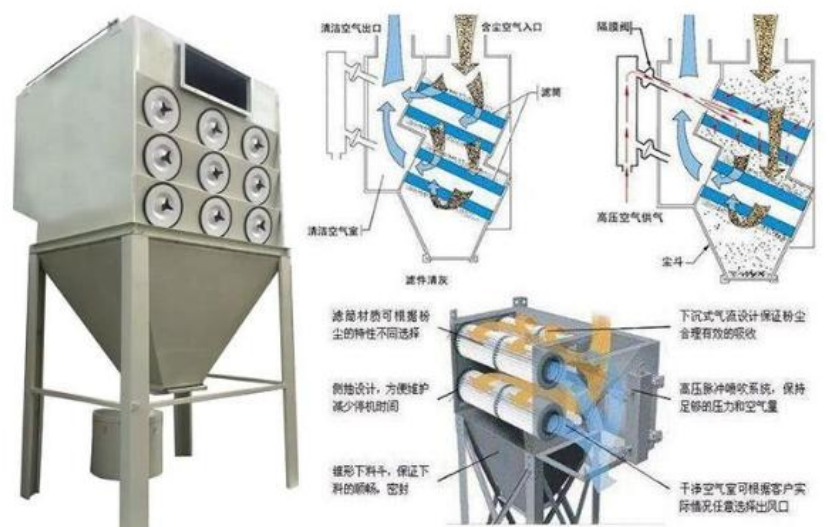
图 4-3 滤筒除尘器工作原理图
