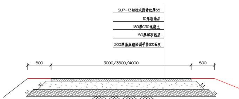
图 2-7 新建沥青砼路断面图
