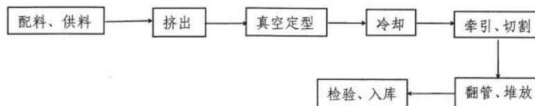
图2-4 PE实壁管生产线工艺流程图
