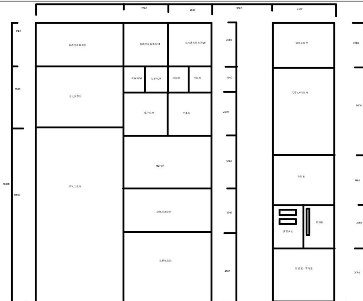
图 4-3 生化废水站池体布局图
